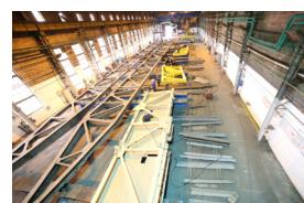
Способы сварки - полуавтоматическая сварка в среде защитных газов, ручная электродуговая сварка штучными электродами, ручная аргонодуговая сварка. Максимальная масса свариваемых металлоконструкций – 30 т.
