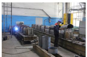
Способы сварки - полуавтоматическая сварка в среде защитных газов, ручная электродуговая сварка штучными электродами.
