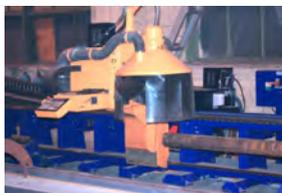
Термическая плазменная резка листового проката толщиной от 1 до 40 мм с минимальной шероховатостью поверхности реза Ra 25. V, Y – образные фаски, размером не менее 5 мм выполняется на машинах плазменной резки **CombiCut 12001.25 PrGr, ECKERT SAPPHIRE BL-2 VORTEX 3D**
