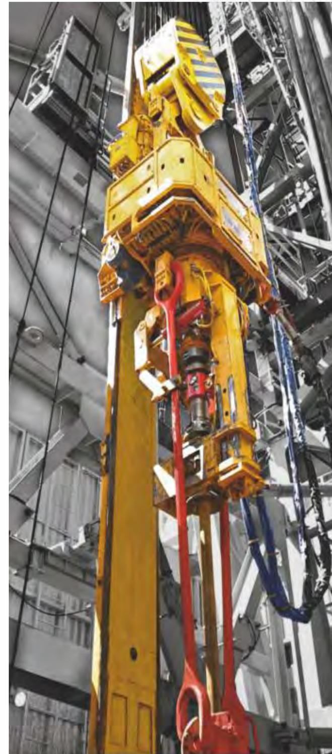
Система верхнего привода (СВП) с частотно - регулируемым приводом переменного тока предназначена для применения в составе буровых установок средней и большой глубины бурения. СВП применяется для работы в макроклиматических районах с умеренным климатом У, категории 1 по ГОСТ 15150-69 (-45°С... +40°С).
